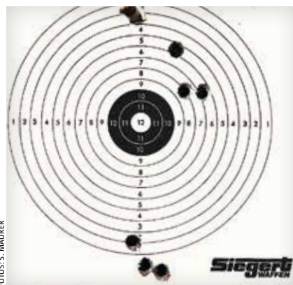
Das bleifreie Brenneke TAG im Kal. .308 Win. hat mit der Steyr-SM 12 bestens harmoniert und auch von der Tötungswirkung überzeugt. Die Scheibe zeigt zwei Schussgruppen (100 m), oben mit Schalldämpfer, unten ohne. Mit einer Treffpunktverlagerung ist generell zu rechnen!
