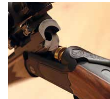
Der Kippblockverschluss ist technisch heute das Maß der Dinge, weil er vor allem ohne Spannungen fest verriegelt.
