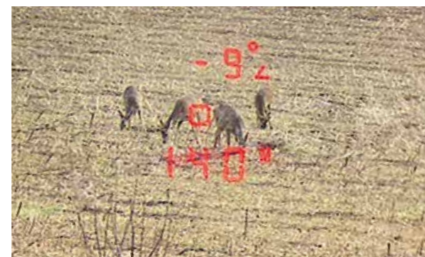
Die Messwerte für Entfernung und Winkel werden in einem kräftigen Rot angezeigt und können in fünf Stufen gedimmt werden.
