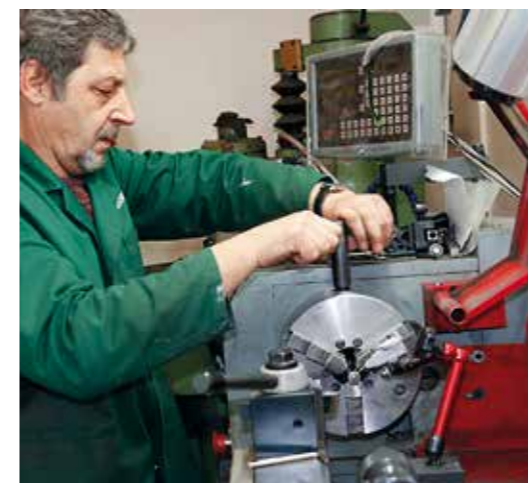
Den gekürzten und gereinigten Lauf in die Drehmaschine einspannen.
