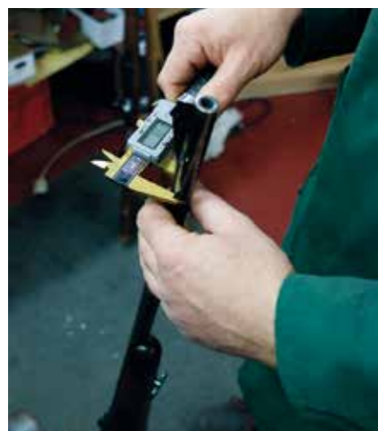
Die Laufmaße ermitteln, um den idealen Gewindedurchmesser zu definieren.
