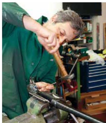
Waffe so weit zerlegen, dass der Lauf in die Drehmaschine eingespannt werden kann.
