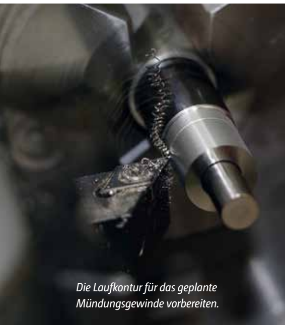
Das metrische Feingewinde in mehreren Arbeitsgängen schneiden.
