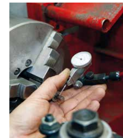
Den Lauf über den Kaliberdorn exakt zentrieren – auf unter 0,05 mm Toleranz.
