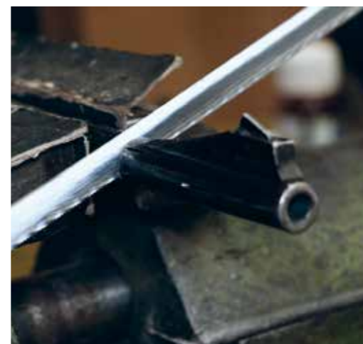
Lauf wenn nötig kürzen, in diesem Fall hinter der Schlitz-Mündungsbremse.
