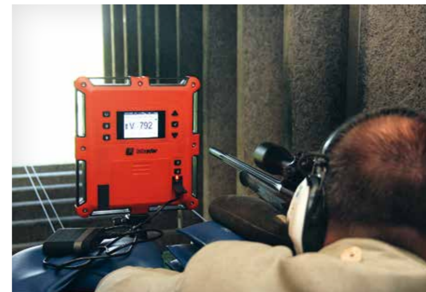
Die Geschwindigkeiten der unterschiedlichen Munitionssorten im Kaliber .308 Win. wurden mit dem „Labrador“ (links) und dem „MagnetoSpeed“ (rechts) ermittelt. Beide Geräte lieferten praktisch identische Ergebnisse, zeigten jedoch auch auf, wie weit die Herstellerangaben in puncto Leistung von den tatsächlichen Werten abweichen.
