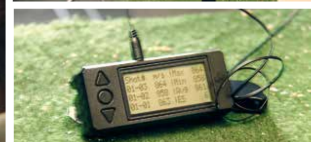
Die Geschwindigkeiten der unterschiedlichen Munitionssorten im Kaliber .308 Win. wurden mit dem „Labrador“ (links) und dem „MagnetoSpeed“ (rechts) ermittelt. Beide Geräte lieferten praktisch identische Ergebnisse, zeigten jedoch auch auf, wie weit die Herstellerangaben in puncto Leistung von den tatsächlichen Werten abweichen.
