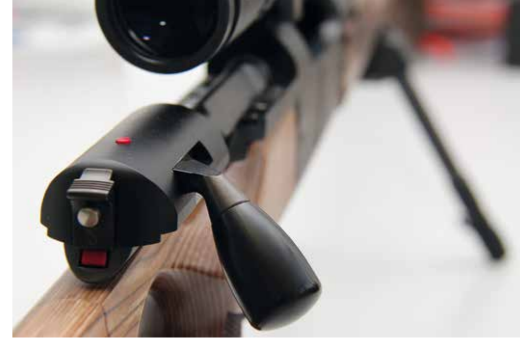
Der geringe Öffnungswinkel des Verschlusshebels beim Strasser Geradzugverschluss ermöglicht das blitzschnelle Repetieren, selbst wenn man die Waffe im Anschlag hat. Der vertikale Sicherungsschieber wirkt auf die Schlagbolzenmutter.
