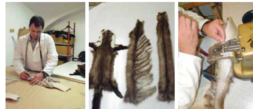
Für die Fertigstellung des Endproduktes braucht es einige Arbeitsschritte. Von der Vorsortierung der Felle und den Auslassarbeiten bis hin zum fertigen Vernähen nimmt beispielsweise eine Jacke je nach Ausführung etwa 80 Arbeitsstunden in Anspruch.
