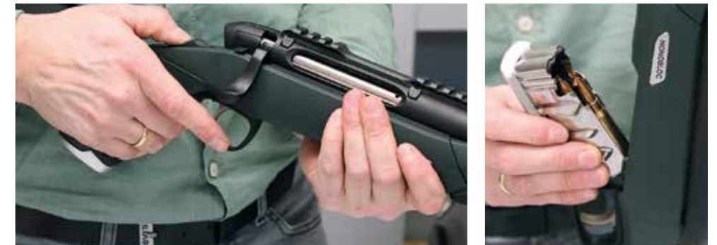
Obwohl der Schaft im Bereich des Systems schlank geblieben ist, finden im Stahlmagazin in Kastenbauweise immer noch vier Patronen Platz.
