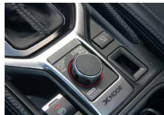
Das stufenlose CVT-Getriebe liefert über drei Ansteuerungsmodi immer das passende Drehmoment im Gelände.
