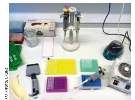
Ein typischer, unspektakulär wirkender Arbeitsplatz im Labor. Hier werden Tausende Proben an verschiedenen genetischen Markern untersucht. Gearbeitet wird mit minimalen Mengen an Chemikalien (Mikroliter). Verarbeitete Proben durchlaufen dann in Thermozyklern die PCR, bevor sie zur Fragmentlängenanalyse auf die Kapillarelektrophorese kommen.
