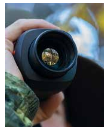
Die vergütete 35-mm-Linse leitet die Infrarotstrahlung auf den Vanadiumoxid-Sensor weiter.
