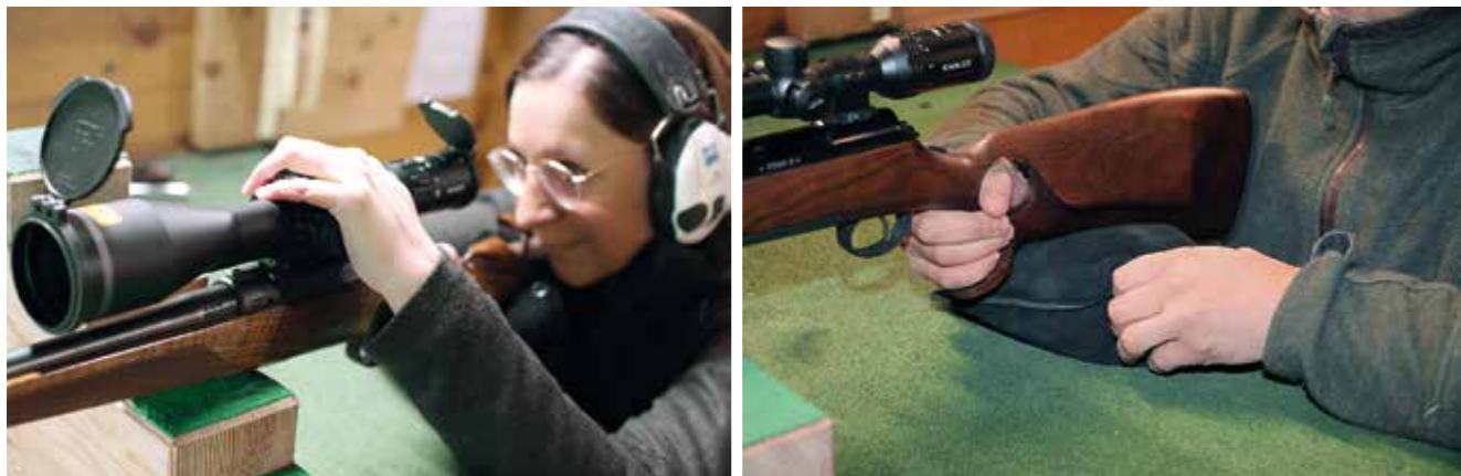
Immer wieder beobachtet man, wie Schützen die Waffe durch Niederdrücken am Zielfernrohr fixieren. Aus mehreren Gründen ist davon abzuraten (l.). Über den schräg zulaufenden Hinterschäft lässt sich die Höhenposition variieren, indem ein Sandsäckchen nach vorne oder hinten verschoben wird.
