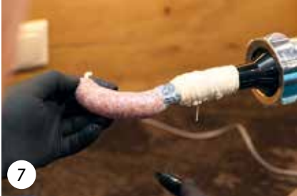
7 Eine konstante Geschwindigkeit der Füllmaschine liefert beste Ergebnisse.
