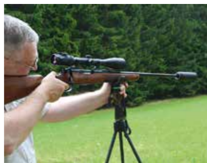
Der STI 3D von Recknagel eignet sich bis zu einer Laufstärke von 22,5 mm und selbst für Hochleistungskaliber.
