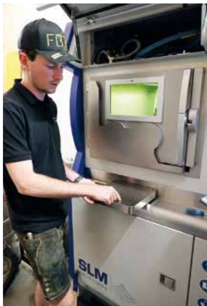
Die Titan-Schalldämpfer entstehen in einem 3-D-Drucker, in dem ein Laser das feine Metallpulver schichtweise verschweißt. Bis auf das Einfräsen des Gewindes und die Oberflächenbehandlung sind keine weiteren Arbeitsschritte mehr nötig.
