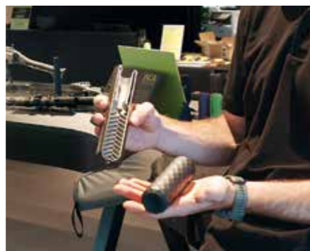
Die Titan-Schalldämpfer entstehen in einem 3-D-Drucker, in dem ein Laser das feine Metallpulver schichtweise verschweißt. Bis auf das Einfräsen des Gewindes und die Oberflächenbehandlung sind keine weiteren Arbeitsschritte mehr nötig.
