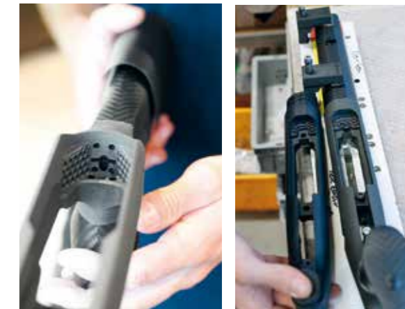
Die Verbindung von Mittelschaft aus Polymer mit Vorder- und Hinterschaft aus Carbon erfolgt über ein mechanisches Stecksystem, in dem der eingespritzte Kleber für formschlüssigen und dauerhaften Halt sorgt.
