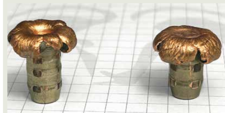
Die deformierten Geschoße des Blaser CDX auf 400 m (links) und auf 100 m (rechts). Die vierfache Distanz halbiert in etwa die Geschoßgeschwindigkeit. Das CDX spricht schon beim Eindringen schnell an. Rechts: deutlicher Ausschuss durch deformiertes CDX bei einem Schmalreh auf 140 m.
